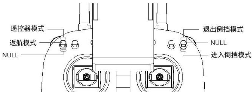
5. 倒档：在遥控模式下，倒挡开关拨杆到最下，进入倒档模式；倒挡开关拨杆到最上档位可以退出倒档。
